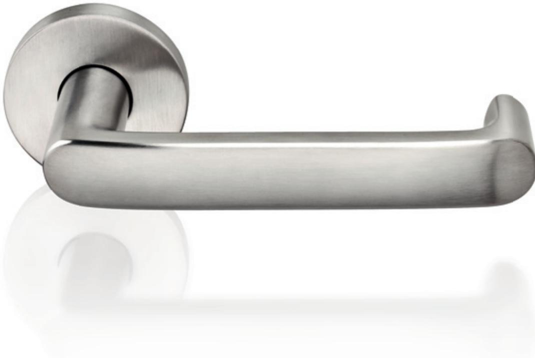
Die innovative Technik der DIRIGENT-Drückergarnituren sorgt für eine wartungsfreie und dauerhafte Funktion. Im Dauerfunktionstest nach EN 1906 ist der DIRIGENT mit mehr als 1,5 Mio. Betätigungen geprüft und zertifiziert. Die Unterkonstruktion der Drückergarnitur hat eine Federvorspannung, d. h. eine eingebaute Hochhaltefeder, die den Türdrücker nach Betätigung in seine Ruhestellung zurückstellt. Mit der Schnellmontagetechnik wird die Garnitur mühelos und ohne sichtbare Befestigungen eingebaut.
