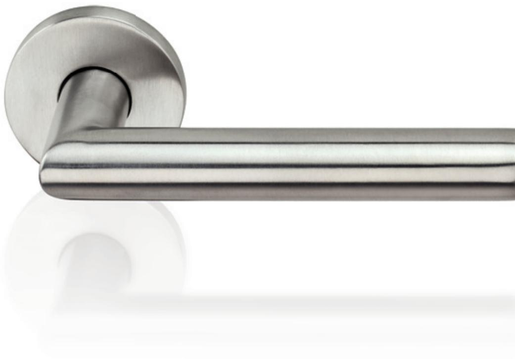
Die innovative Technik der BELCANTO-Drückergarnituren sorgt für eine wartungsfreie und dauerhafte Funktion. Im Dauerfunktionstest nach EN 1906 ist der BELCANTO mit mehr als 1,5 Mio. Betätigungen geprüft und zertifiziert. Die Unterkonstruktion der Drückergarnitur hat eine Federvorspannung, d. h. eine eingebaute Hochhaltefeder, die den Türdrücker nach Betätigung in seine Ruhestellung zurückstellt. Mit der Schnellmontagetechnik wird die Garnitur mühelos und ohne sichtbare Befestigungen eingebaut.
