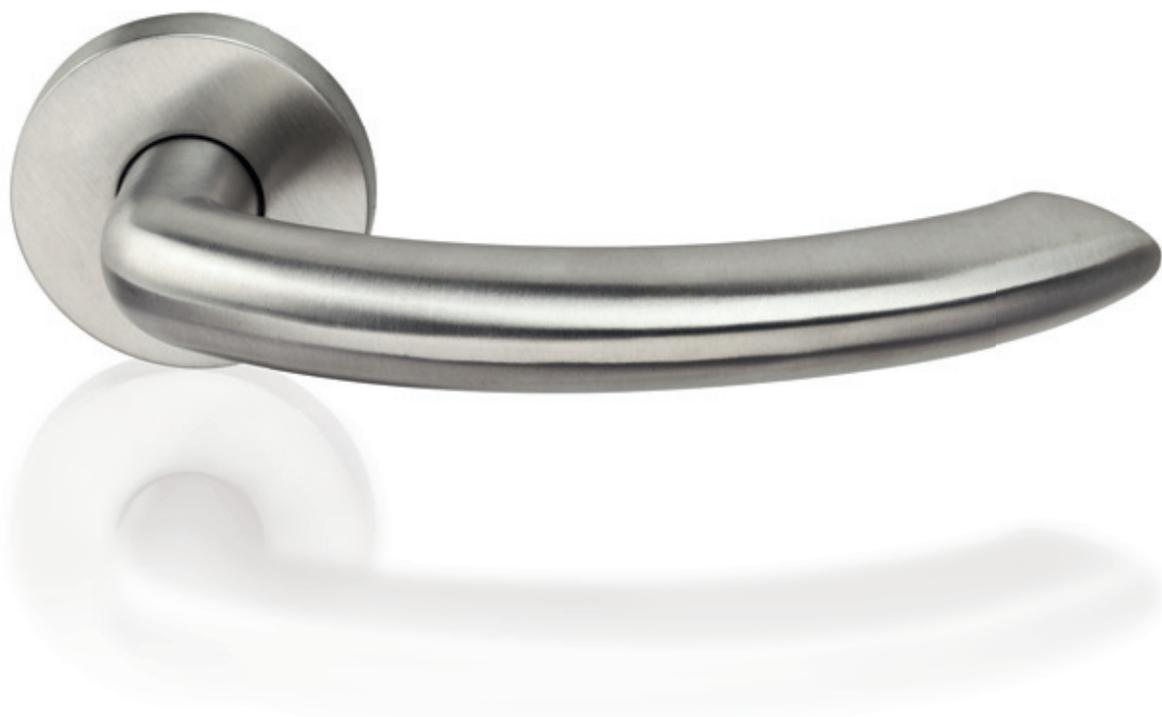
Die innovative Technik der LEGATO-Drückergarnituren sorgt für eine wartungsfreie und dauerhafte Funktion. Im Dauerfunktionstest nach EN 1906 ist der LEGATO mit mehr als 1,5 Mio. Betätigungen geprüft und zertifiziert. Die Unterkonstruktion der Drückergarnitur hat eine Federvorspannung, d. h. eine eingebaute Hochhaltefeder, die den Türdrücker nach Betätigung in seine Ruhestellung zurückstellt. Mit der Schnellmontagetechnik wird die Garnitur mühelos und ohne sichtbare Befestigungen eingebaut.
